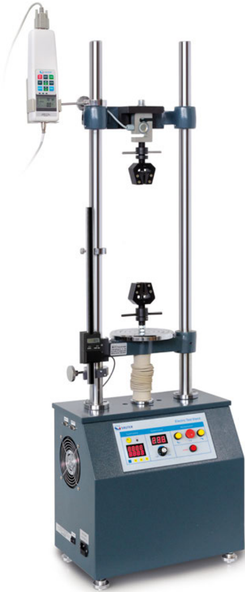
Banc d'essai avec moteur électrique pour les mesures standard
