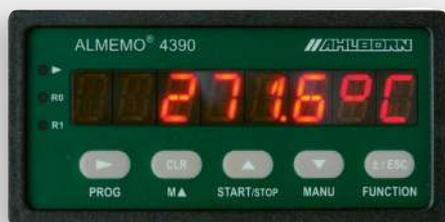
**Appareil de mesure ALMEMO® de précision en boîtier intégrable en tableau. Avec fonction d'acquisition de données, multiples fonctions pour tous les domaines d'application. Précision accrue de la mesure, cadence de mesure élevée.**
