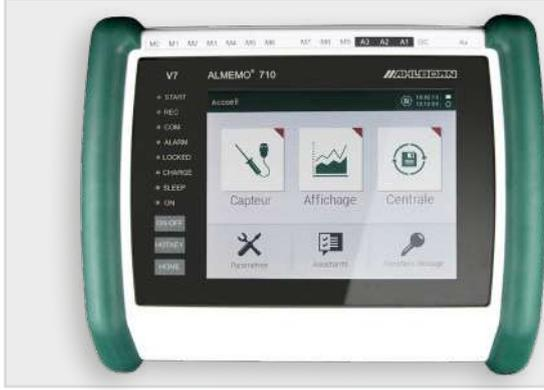
**Appareil de mesure ALMEMO® de précision de la nouvelle génération V7 avec fonction centrale d'acquisition et écran tactile.**
