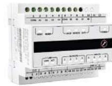
Le MES-D-4-4 dispose de 4 sorties relais pour le contrôle de l'appareil et de 4 entrées opto-isolées (contact humide). Les relais ainsi que les entrées peuvent être contrôlés via LAN / WAN (les protocoles pris en charge sont indiqués ci-dessous). L'onglet principal indique le nombre d'entrées/sorties, le nom attribué, l'état changeant et l'indicateur montrant l'état actuel.
